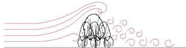
neprodouvavý ochranný lesní pás, M 1:200 víření vzduchu do vzdálenosti až 5 násobku výšky stromu
