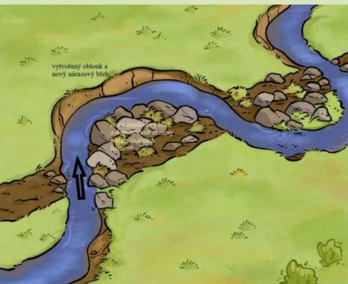
1. Přeformátování upraveného koryta - rozvlnění
