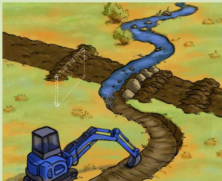
4. Vyměščení a rozvlnění upravených koryt v trase původního potoka
