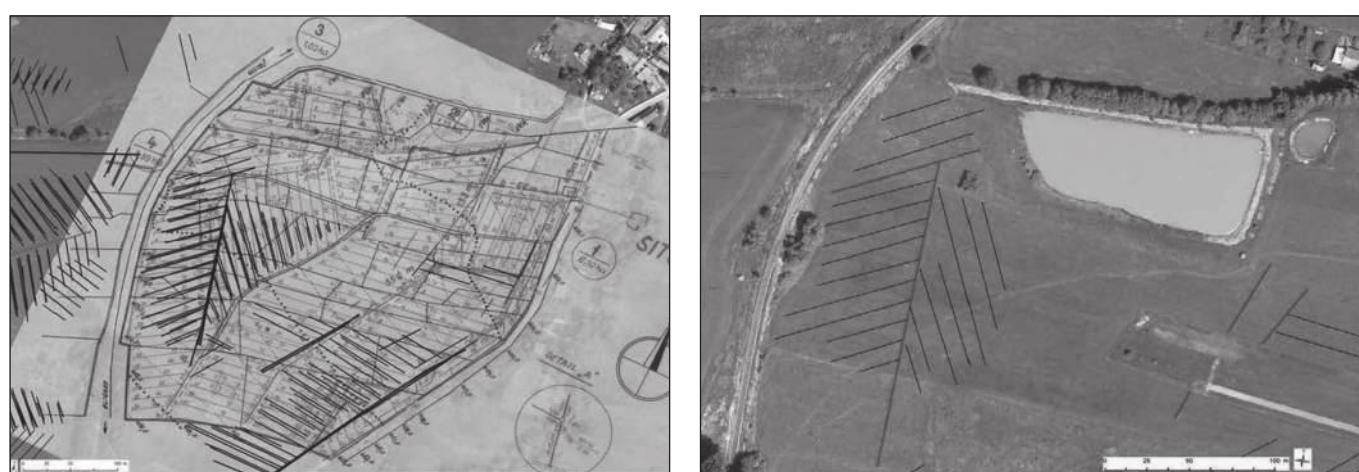
Obr. 8 – ukázka konkrétního využití dostupných podkladů (PD) a cíleného snímkování pro účely výstavby soustavy malých vodních nádrží s využitím drenážních vod
