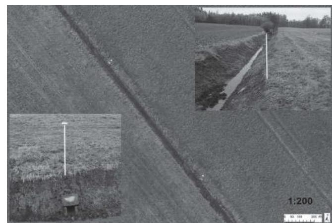
Obr. 9 – ukázka osazení výusti drenážního systému (dle přihlášeného užitného vzoru 2017-34258) v terénu (horní část obrázku), v dolní části osazení výusti v rámci provádění údržby HOZ, na pozadí vizualizace signalizovaných výustí na pořízeném snímku. Účelem signalizace výustí tímto způsobem je jejich snadná identifikovatelnost jak v terénu, a to i z poměrně velké vzdálenosti, zatímco ve vegetačním období ani přímým průchodem korytem často nelze výusti dohledat, tak na snímcích pořízených DPZ
