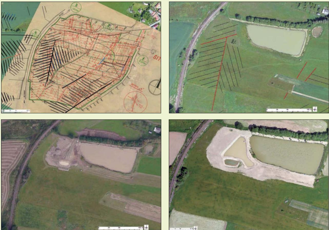
Obr. 8 – ukázka konkrétního využití dosupných podkladů (PD) a cíleného snímkování pro účely výstavby soustavy malých vodních nádrží s využitím drenážních vod
