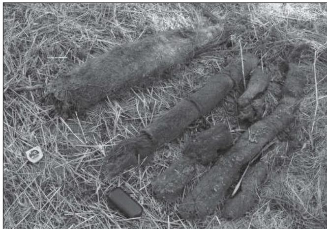
Obr. 10 – ukázka kořenového systému břehových porostů vrba rostoucích v blízkosti výstřelu – kořenový systém dokáže prorůst drenážní trubky různé světlosti (zde 13 a 6,5 cm) v celém profilu a v délce i 10 m, takže zcela znemožní funkční odvádění drenážního vod z plochy pozemku a znehodnotí i vlastní drenážní trubky.
