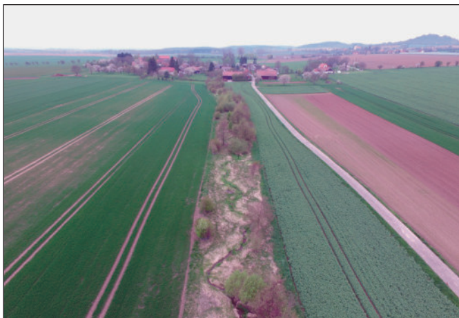
Obr. č. 2 – Příklad revitalizace (RVT) HOZ v k.ú. Vesec u Jičína – součást lokálního biokoridoru (šířka meandrujícího pásu Ø 20 m s bočními a průtočnými tůňmi)
