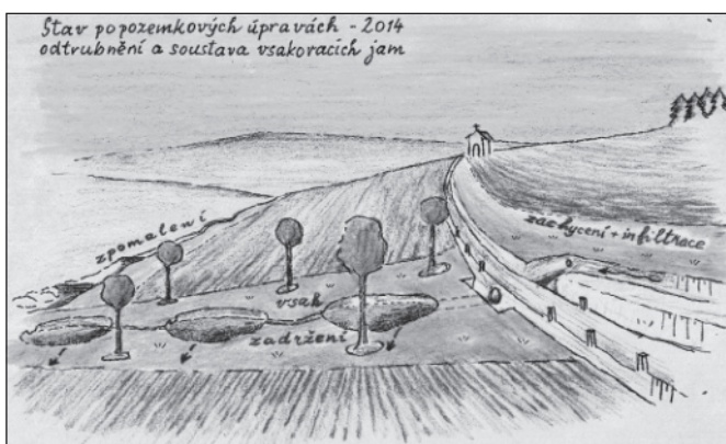
Obr. 3 Stav po realizaci soustavy opatření záchytného příkopu, vsakovacích jam, revitalizace toku a ochranného zatravnění (Mazín, 2016)
