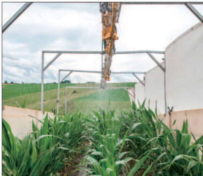
Simulátor deště a jeho využití při stanovení C faktoru (foto: M. Místr)
