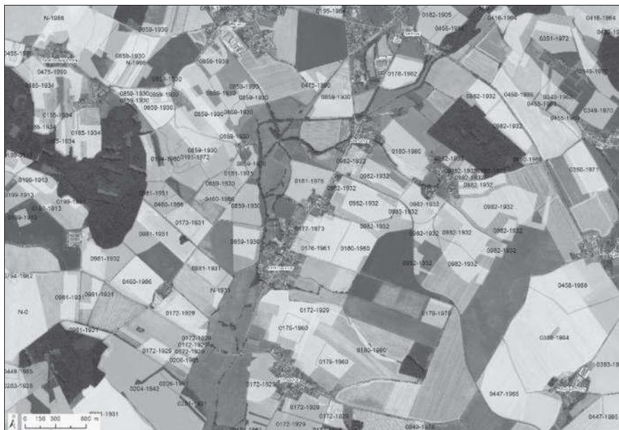
Obr. 1 Ukázka polygonové vrstvy evidovaných staveb odvodnění (volně stažitelná data [www.eagri.cz](http://www.eagri.cz)) s uvedeným číslem stavby a rokem výstavby (okres Hr. Králové).
