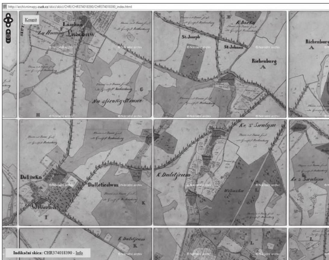
Obr. 4 – Ukázka odlišného zákresu linií HOZ, resp. melioračních kanálů (okres Chrudim). V tomto případě jsou na stavbě HOZ vybudované vodní nádrže! Historicky se jedná o drobné vodní toky, jak dokládá obr. 5 – ukázka indikační mapy stabilního katastru 1:2 880 z roku 1939.
