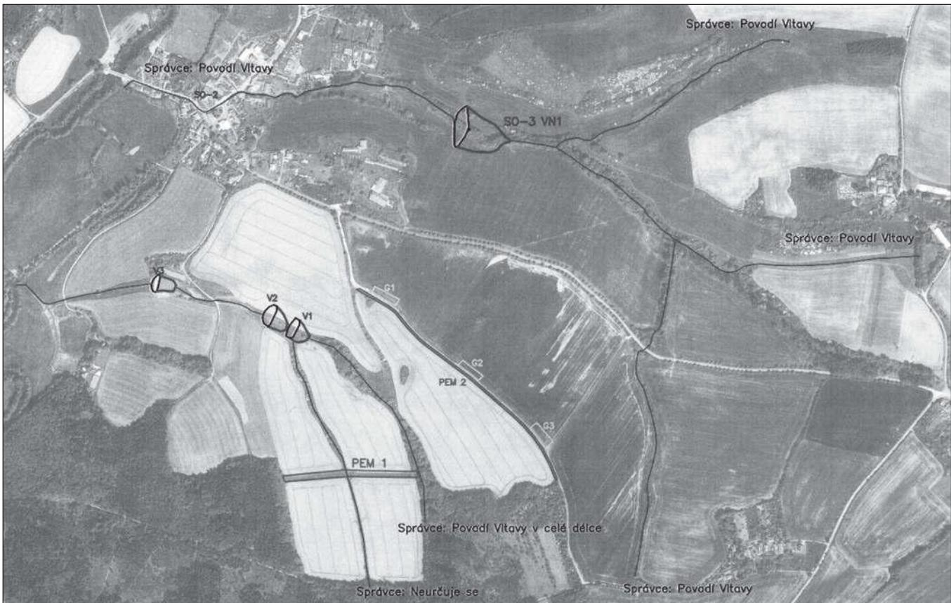
Obr. 5 Snímek skutečného stavu 2017 před dokončením staveb polosuché nádrže VN1 a V1 a V2. Zákresy realizovaných opatření jsou schématické. Snímek dokládá vysoký podíl orné půdy a půdních bloků osetých řepkou.
