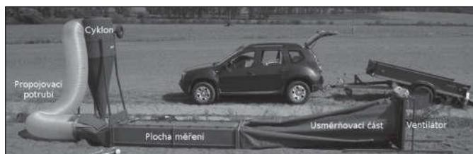
Obrázek 2: Technické řešení větrného tunelu.
