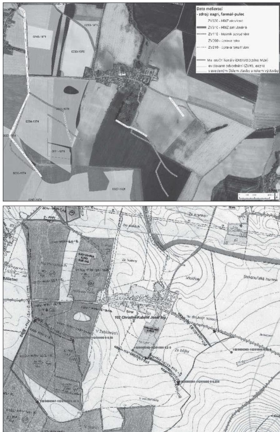
Obr. 3 – Ukázka rozdílů v geometrii a polohovém umístění liniových prvků (otevřených a zakrytých – zatrubněných HOZ) dle informačních portálů eagri.cz, DIBAVOD (horní část obrázku) a dle portálu VHS SPÚ (dolní část obrázku), lokalita Ostrov, okres Chrudim
