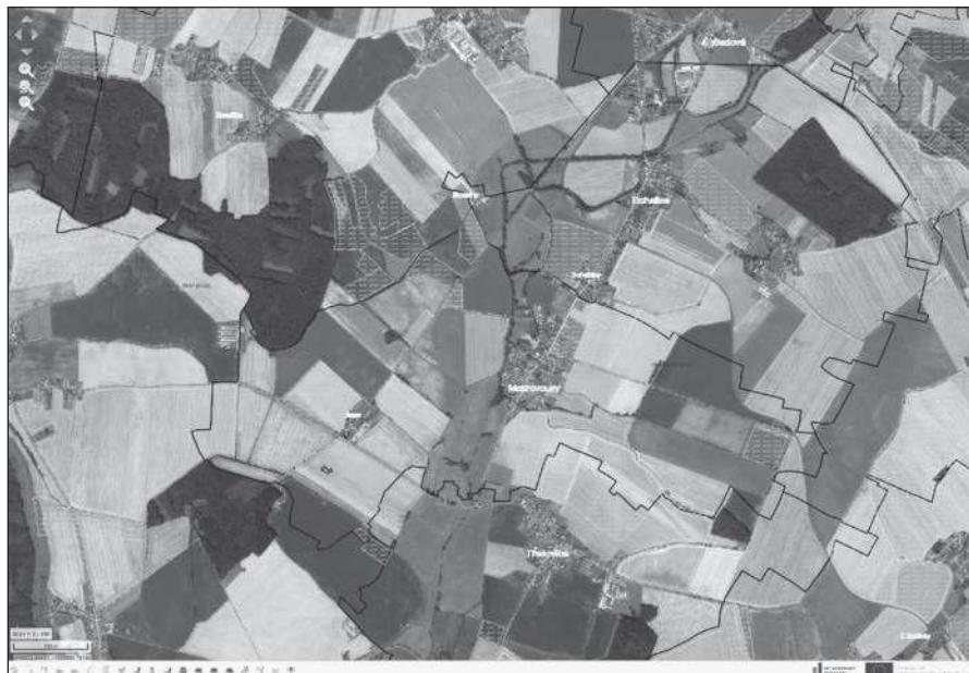
Obr. 2 Screen portálu LPIS stejně lokality – plochy odvodnění tematické vrstvy Meliorace, dokládající zcela zásadní nesoulad digitalizovaných vrstev a v důsledku tak i poskytování zkreslených a zavádějících informací o existenci plošného odvodnění na pozemcích. V tomto případě zcela chybí zákres starších staveb odvodnění (rok výstavby 1930–1932).
